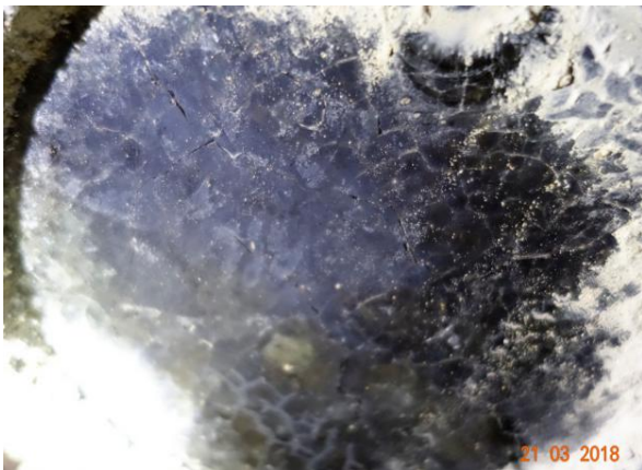
副仓照明灯玻璃高温碎裂形态
