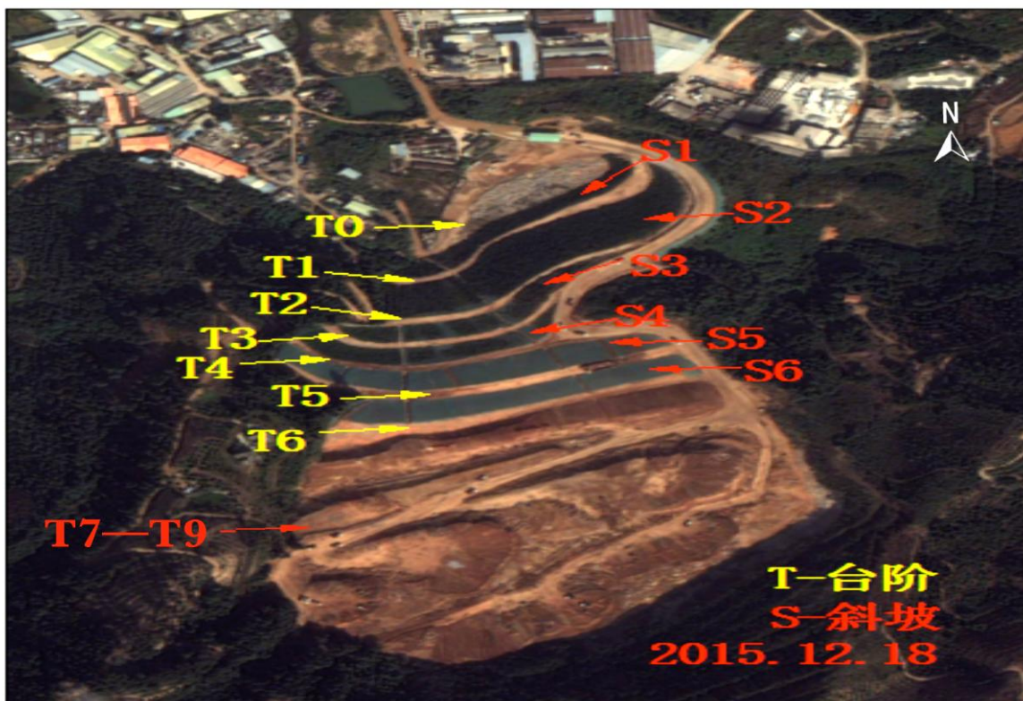
图 3 事故发生前红坳接纳场各级台阶分布示意图
